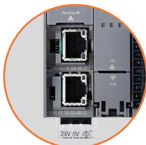
Dual Ethernet port. Jeden port může být nastaven pro datovou komunikaci, jako je FTP, Web Server a E-mail, a druhý port může být nastaven pro řídicí síť včetně Modbus TCP.
