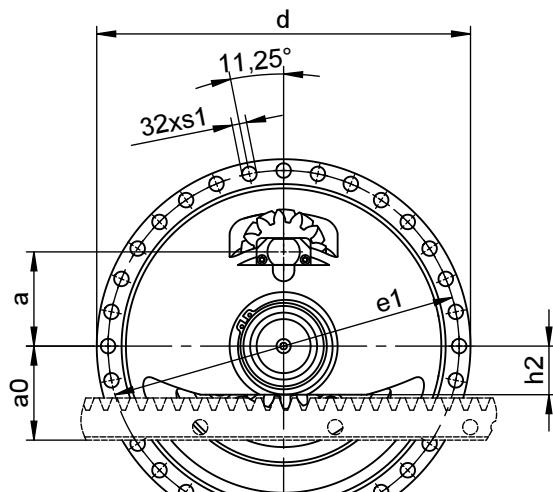
1) Optional Schmierung durch integriertes Filzzahnrad!
