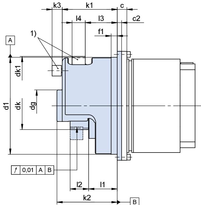
1) Optional Schmierung durch integriertes Filzzahnrad!
