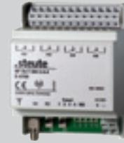
Die Auswertung der Signale übernimmt eine Empfangseinheit im Schaltschrank der Anlage. Dabei können zwei Sender auf einen Empfänger einwirken.
