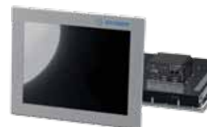
Motion kontroler MC6 – verze s dotykovým displejem
