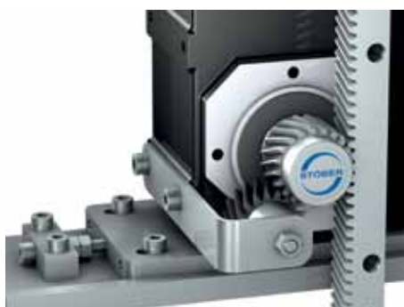
Nastavovací deska pro převodovky, mazací pastorek, pastorek v montážní poloze S – ozubení je blíže k převodovce
