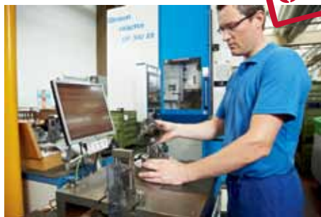
100% mechatronická kontrola vnitřního ozubení
