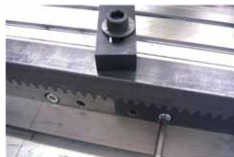
Ukázka montáže ozubených hřebenů za sebe pomocí montážního protikusu
