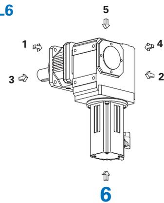
Die Getriebe sind mit der auf dem Typschild angegebenen Menge und Art des Schmierstoffs befüllt. Die Schmierstoff-Füllmenge und der Aufbau der Getriebe sind von der Einbaulage abhängig.
