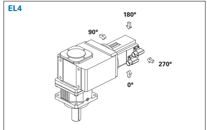
**Beispiel:** Einbaulage EL1 / EL4 mit Steckverbinder in 270°-Position (**Standard**) (Kabeleinführung Seite A)
