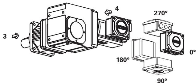
**Beispiel:** Planetengetriebe auf Seite 3, Einbaulage EL1, Klemmenkasten in 0°-Position
