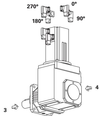
**Beispiel:** Planetengetriebe auf Seite 3, Einbaulage EL5, Steckverbinder in 270°-Position
