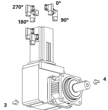
**Beispiel:** Planetengetriebe auf Seite 4, Einbaulage EL5, Steckverbinder in 270°-Position
