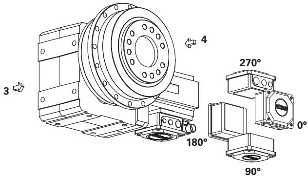
**Beispiel:** Planetengetriebe auf Seite 4, Einbaulage EL1, Klemmenkasten in 90°-Position
