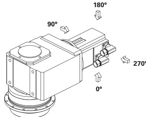
**Beispiel:** Einbaulage EL1 / EL4 mit Steckverbinder in 270°-Position (**Standard**) (Kabeleinführung Seite A)
