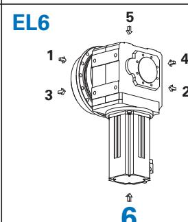
**Die Getriebe** sind mit der auf dem Typschild angegebenen Menge und Art des Schmierstoffs gefüllt. Die Schmierstoff-Füllmenge und der Aufbau der Getriebe sind von der Einbaulage abhängig.
