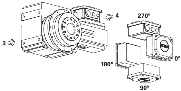
**Beispiel:** Planetengetriebe auf Seite 4, Einbaulage EL1, Klemmenkasten in 270°-Position
