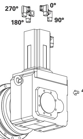
**Beispiel:** Planetengetriebe auf Seite 3, Einbaulage EL5, Steckverbinde in 90°-Position
