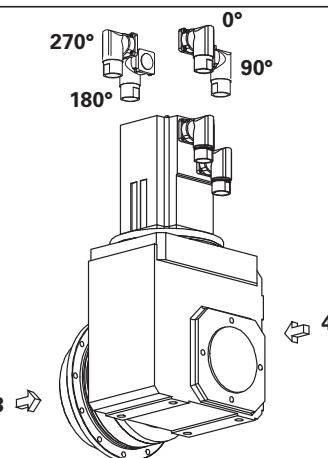
**Beispiel:** Planetengetriebe auf Seite 3, Einbaulage EL5, Steckverbinde in 0°-Position
