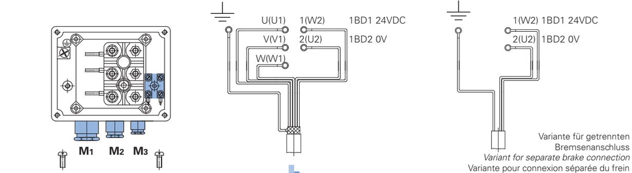
Anschluss an Servomrichter (U, V, W)
