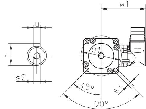
mit Bremse + EnDat®-Absolutwertgeber / with brake + EnDat® absolute value encoder / avec frein + codeur absolues EnDat®
