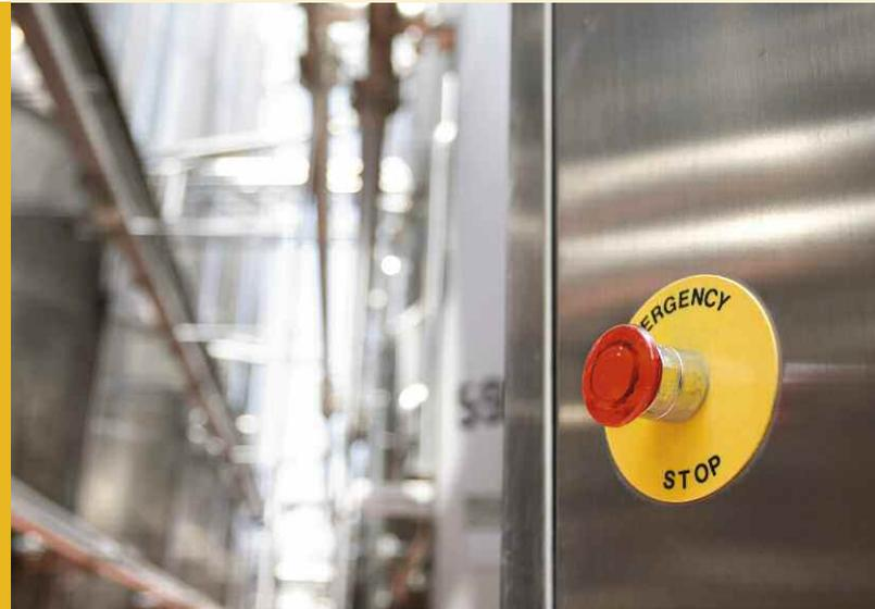
Die Ex Befehlsgeräte der Baureihe Ex 14 werden in Schaltschränken, -Schalttableaus, -Zweihandbedienpulten und an Maschinen eingesetzt. Ex Befehlsgeräte werden allgemein zum manuellen Einleiten oder Abschalten von Arbeitsabläufen eingesetzt.
