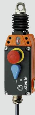
Ex Seilzug-Notschalter werden an Maschinen und Anlagenteilen angebracht, die nicht durch Sicherheitsabdeckungen abgesichert werden können. Im Gegensatz zum Ex Not-Aus-Pilzdrucktaster kann beim Ex Seilzug-Notschalter an jedem Punkt des Seiles die Not-Aus-Funktion ausgelöst werden. Alle Ex Seilzug-Notschalter entsprechen der Europannorm EN ISO 13850 und EN 60947-5-5.
