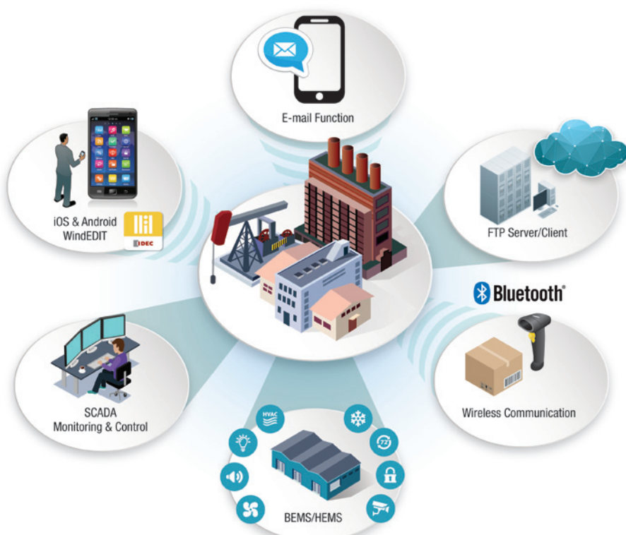
Dual Ethernet port. Jeden port může být nastaven pro datovou komunikaci, jako je FTP, Web Server a E-mail, a druhý port může být nastaven pro řídicí síť včetně Modbus TCP.
