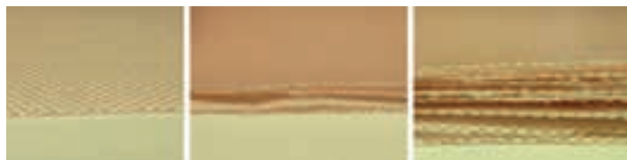
Stanovení počtu vrstev tkanin při výrobě airbagových polštářů
