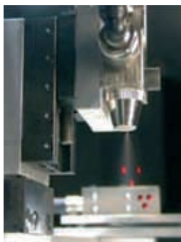
Kontrola kvality postřiku – detekce ucpaných nebo špatně nastavených trysek
