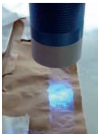
Kontrola fluorescentního lepidla na papírových sáčcích nebo brusných papírech
