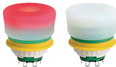
prosvětlená varianta řady XA – barva tlačítka bílá vizuální kontrola stavu – aktivní (červené prosvícení), neaktivní (bílé)
