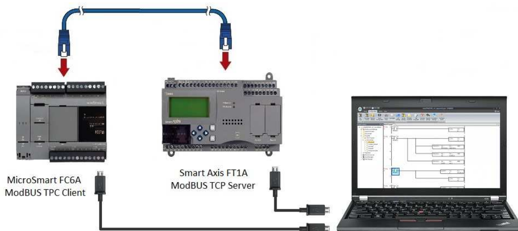
Obr. 2 Zapojení obou PLC pomocí síťového kabelu a PC připojováno pomocí USB kabelu
