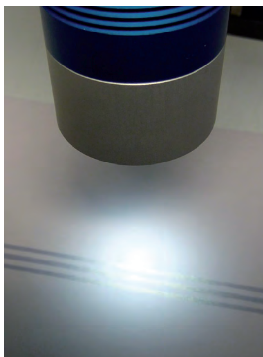
Detekce barevných perleťových proužků na bezpečnostním papíru
