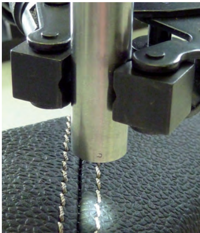
Detekce různých barev a odstínů nití/švů kůže a textilií
