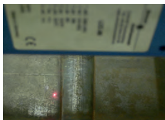
Detekce svárů na ocelových trubkách
