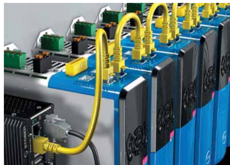
Servoměniče pro víceosé operace jsou pomocí komunikace EtherCAT kontrolovány Motion kontrolerem MD6.
