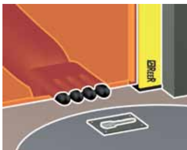
Modely s rozlišením 30 mm montované do tvaru L zaručují rozlišení 40 mm v místě spojení.
