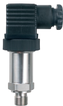
typ DLMx/A napájení: 15–24 V DC spotřeba proudu: max. 0,5 W výstup: 4–20 mA
