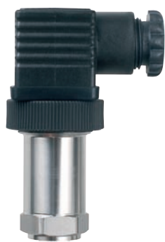
typ DLMx/V napájení: 15–24 V DC / 24 V AC (±10%) spotřeba proudu: typ. 0,15 W / 0,3 VA výstup: 0–10 V
