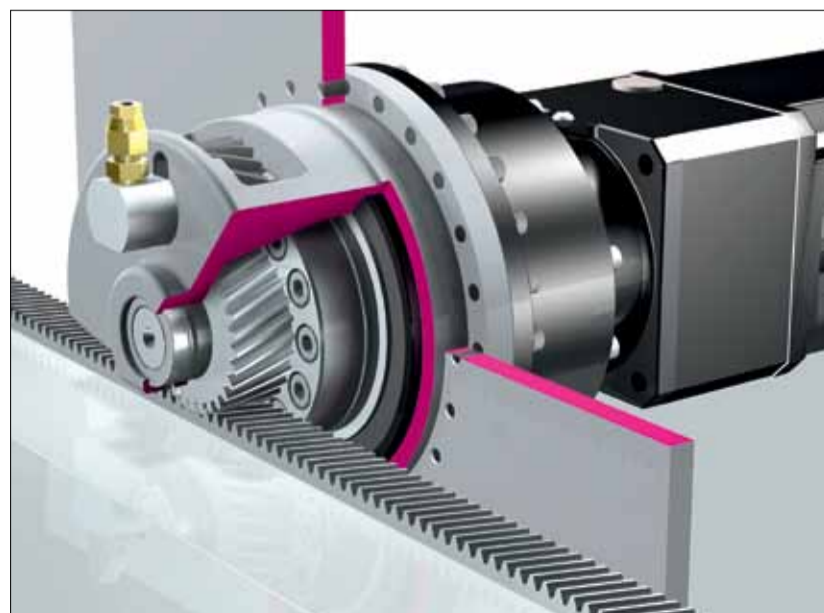
Hřebenové pohony ZTRS-PH(A): zvon podpůrného ložiska a pastorek jsou přišroubovány ke skříně převodovky, respektive k její přírubové hřídeli.
